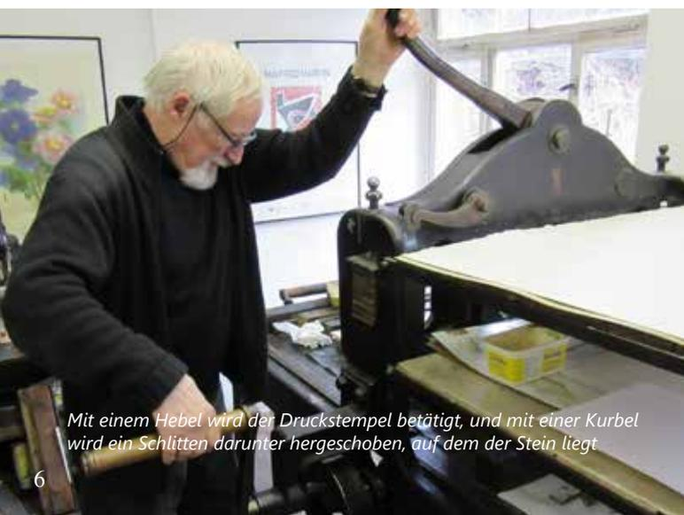
*Mit einem Hebel wird der Druckstempel betätigt, und mit einer Kurbel wird ein Schlitten darunter hergeschoben, auf dem der Stein liegt*
