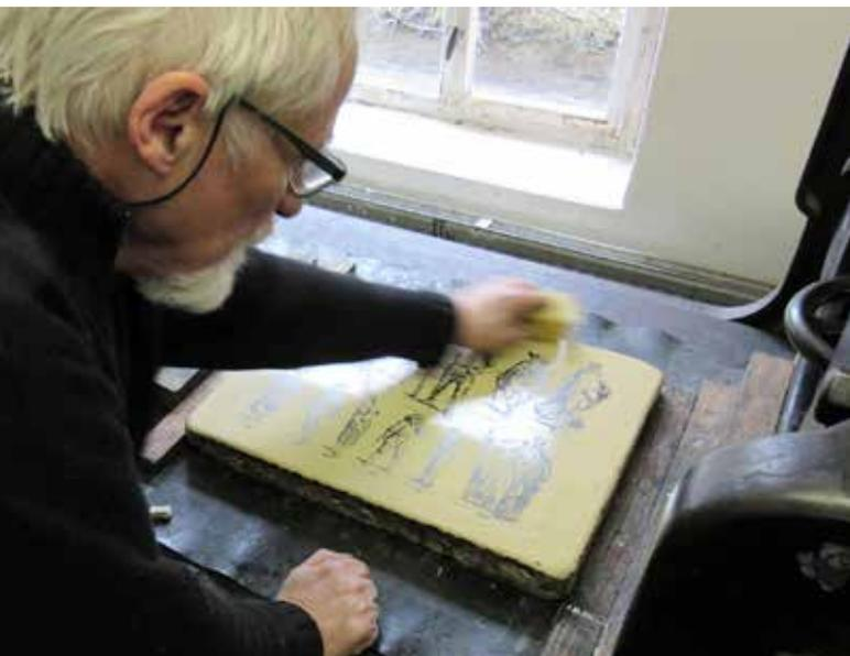
*Der Litho-Stein wird angefeuchtet*
