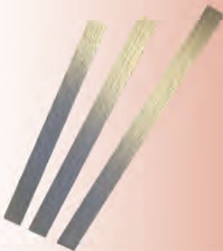
Aluprofile 2x10 mm, mit einer Rohrzanze zu biegen
