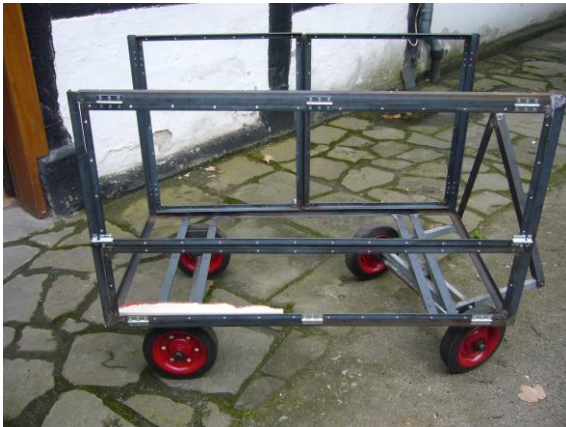
Der geschweißte und noch unlackierte Stahlrahmen
