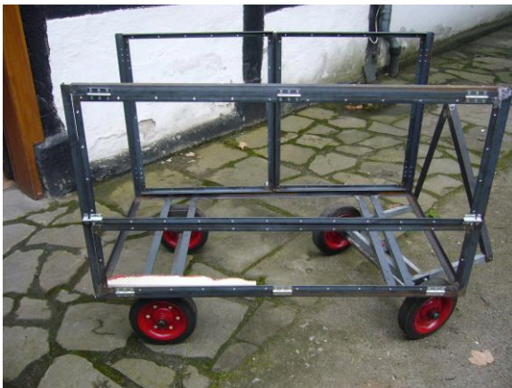
Der geschweißte und noch unlackierte Stahlrahmen
